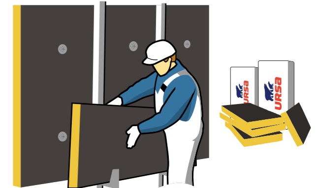
Rysunek 1 – Izolacja fasady wentylowanej metodą lekką-suchą
