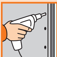
Mocowanie przykręcanie wkrętami do metalowej konstrukcji dolnej
