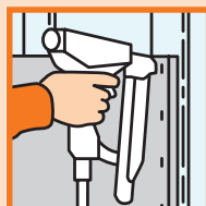
Mocowanie Klamrami do drewnianej konstrukcji dolnej
