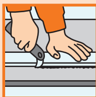
Nacięcie nacięcie nożem FERMACELL
